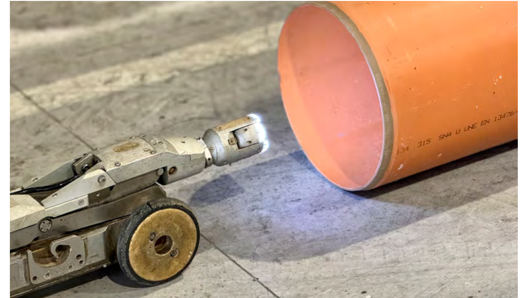
Cámara de inspección da rede de sumidoiros
